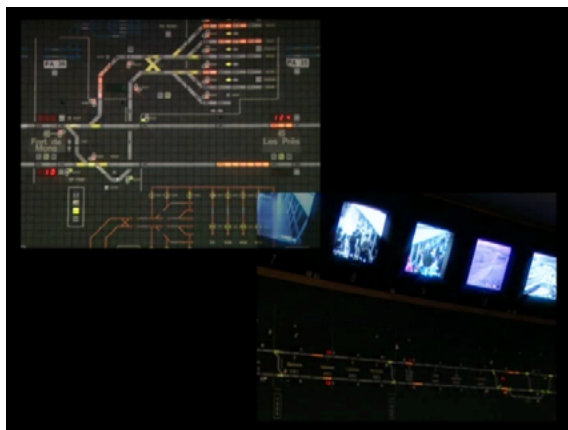
Figura 6 Imagens Operacionais — Geolocalização dos Trens no Painel do Centro de Controle
